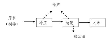
图 2-1 产品生产工艺流程及产污点位图
