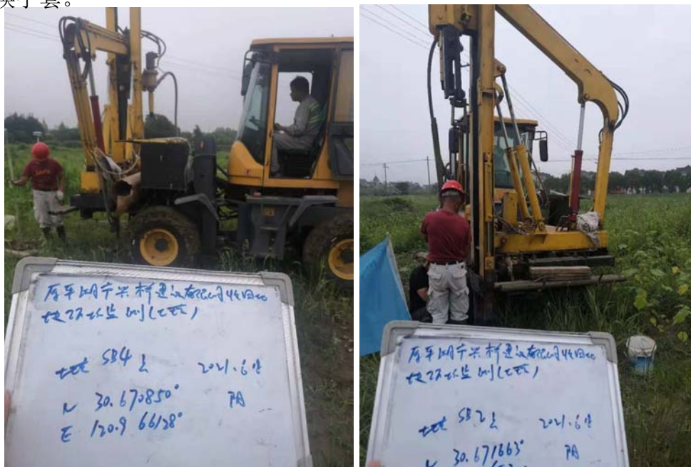
图 5.2-1 现场土壤采样照片
