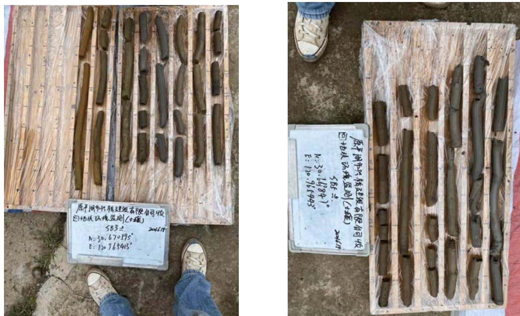
图 5.3-1a 土壤样品取样照片
