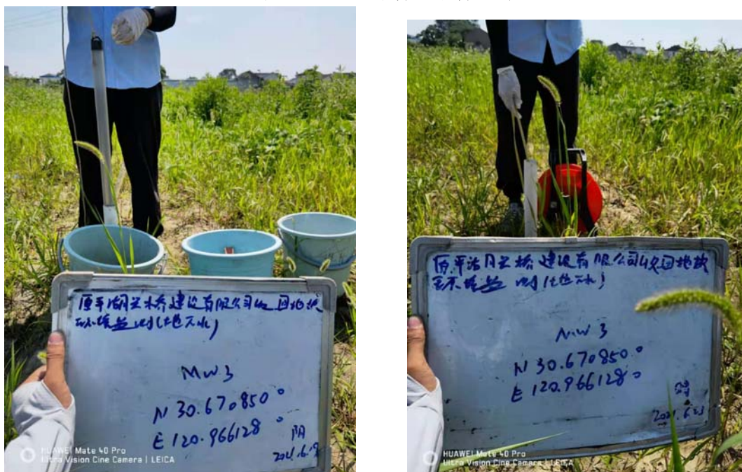
图 5.3-1b 地下水洗井及采样照片
