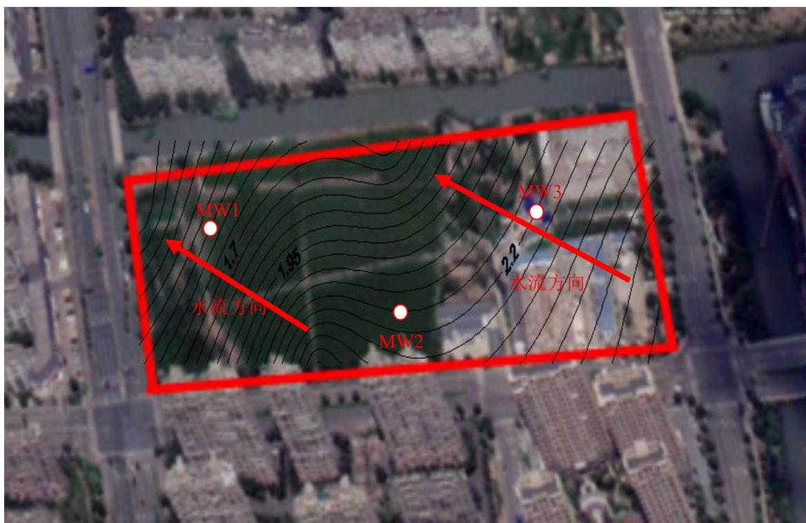
图 3.1-2 地下水水流方向图
