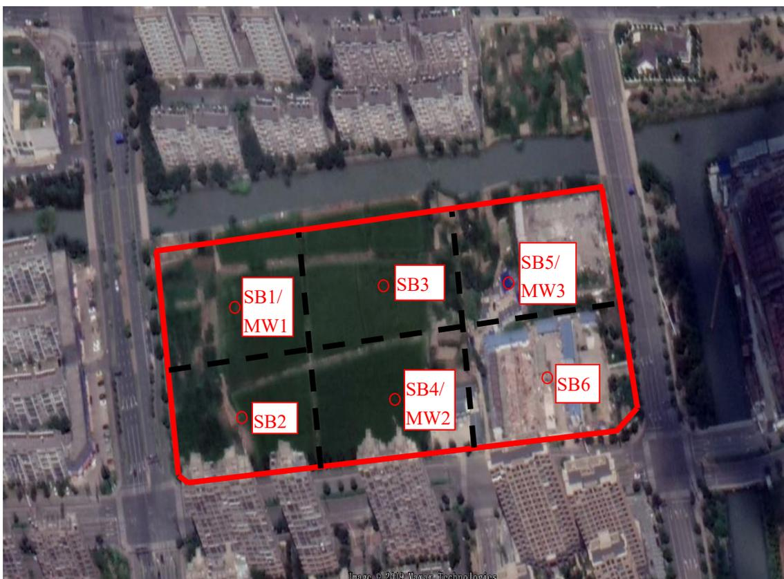
图 4.1-2 初步调查监测方案布点图（现状）
