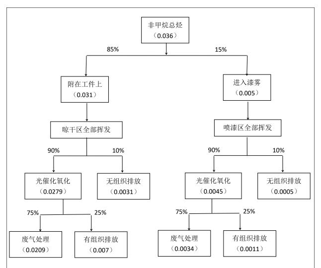
图 5-3 有机废气(非甲烷总烃)平衡图 单位: t/a
