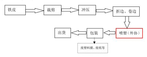
图 5-2 铁制工艺品生产流程及产污图
