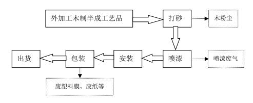
图 5-1 木制工艺品生产流程及产污图
