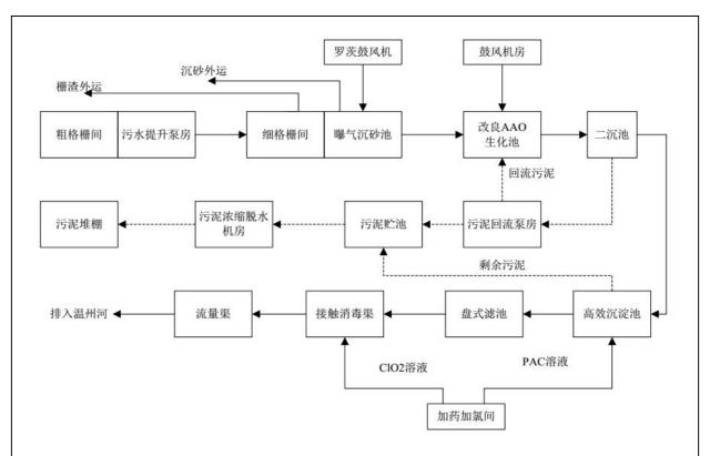
图 2-1 院桥污水处理厂工艺流程图
