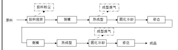
图 7-6 嘉兴君瑞汽车零部件有限公司生产工艺图
