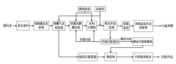
图 2-3 污水厂二期工程工艺流程框图
